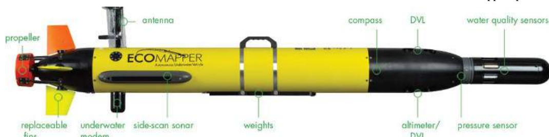
Figura 7 Imatge de l'AUV EcoMapper de YSI. Es poden veure els diferents sensors GPS, DVL, SSS o sensors de la qualitat de l'aigua [11].
